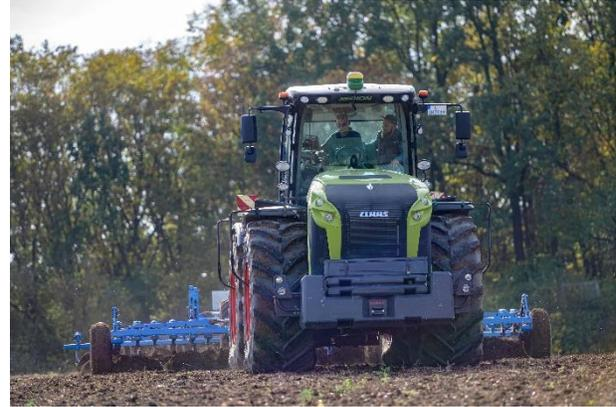
*Bereit für den Transport: Dank VF-Technologie können bis zu 40 Prozent schwerere Lasten zwischen den Standorten von Osterland Agrar GmbH befördert werden.*
